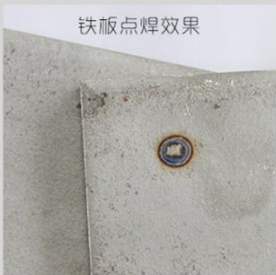
2mm不锈钢板点焊效果
