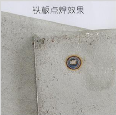
2mm不锈钢板点焊效果
